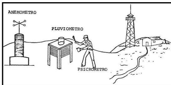
Los instrumentos meteorológicos necesarios para verificar las condiciones esperadas en la atmósfera, son: el anemómetro, el pluviómetro y el psicrómetro.
